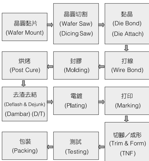
圖 10.42 傳統具有導線架的電子構裝步驟圖。
